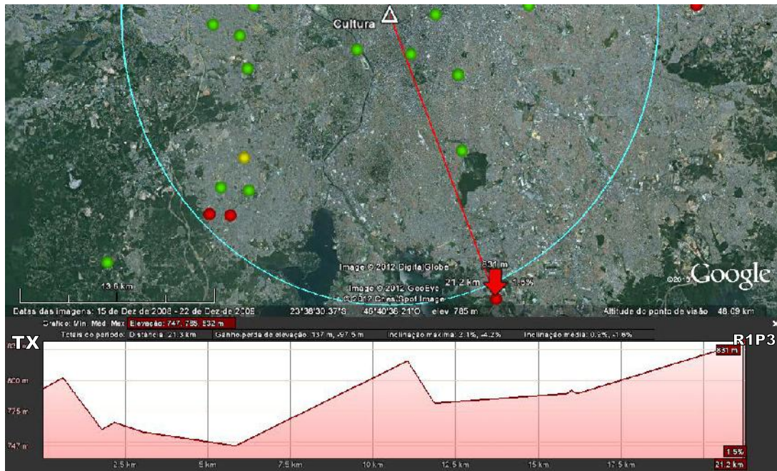
Figura 20-Perfil do terreno entre o centro de transmissão e o ponto R1P3
